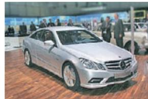
Новое купе E-Class заменит CLK и поступит в продажу в мае этого года. Купе E-класса представлено пятью моделями: двумя бензиновыми и двумя дизельными. 204-сильный 4-цилиндровый E 250 CGI и 292-сильный 6-цилиндровый V6 E 350 CGI оснащаются системой прямого впрыска, которая повышает экономичность почти на 14% по сравнению с уходящей CLK. Восьмицилиндровый двигатель устанавливается на E500 и развивает мощность 388 л.с. Также планируется выпуск AMG-версии в конце этого года.
