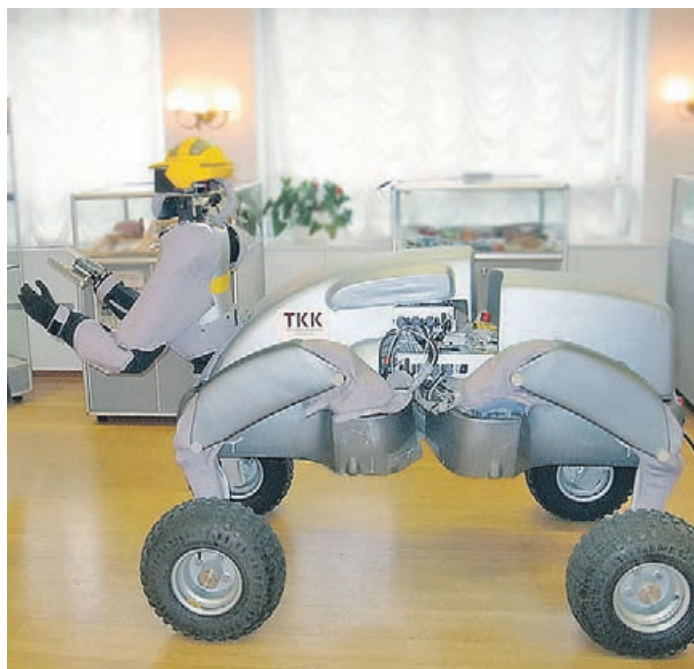
Шагающий-колесный робот-кентавр (WorkPartner)
