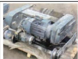
**АГРЕГАТ ДЛЯ МОСТОВОГО ПОДЪЕМНИКА**
