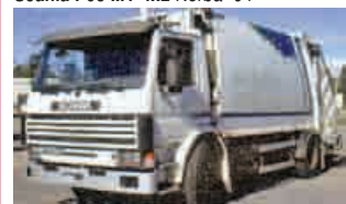
Scania P93 MV 4x2 12/96 NMT укладчик
